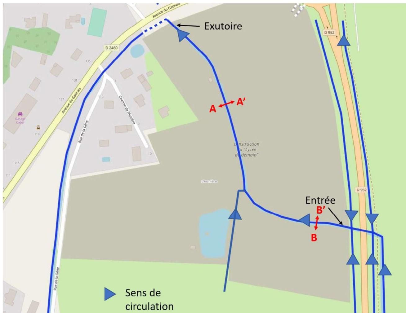
*Schéma du fonctionnement hydraulique du site (emprise du projet en gris).*
